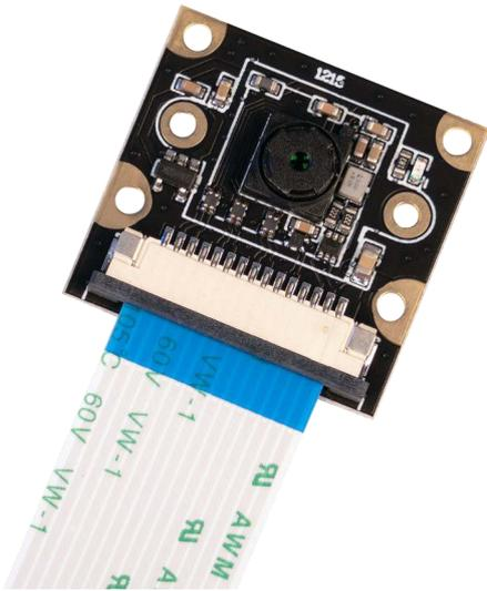
Das Kameramodul für alle Raspberry Modelle arbeitet mit dem bekannten IMX219 Chip und liefert beste Aufnahmen in 8 MP Qualität bei einem Blickwinkel von 120°.
