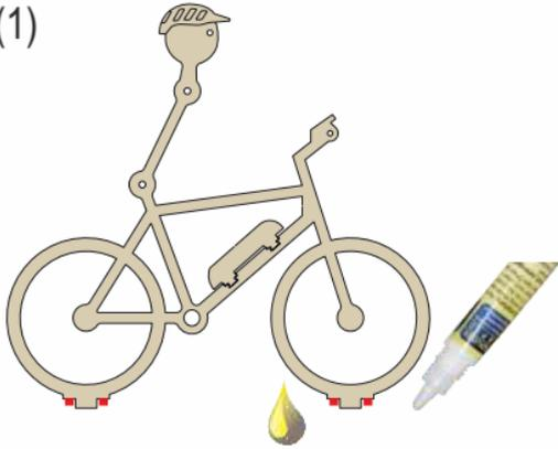
Kleber auf rot markierte Fläche aufbringen, die Radlerfigur auf die Bodenplatte aufstecken und so ausrichten, dass die Zahnräder sauber ineinander greifen und sich der Zahnkranz in der Radlerfigur locker mitdreht.
