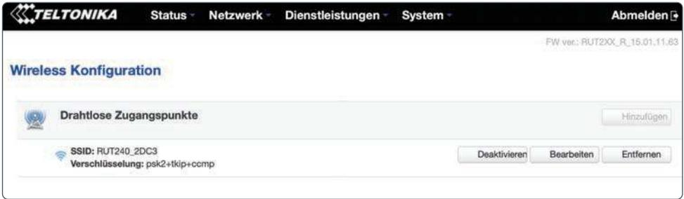
2. Sie werden dann eine Liste der Drahtlosen Zugangspunkte (Hotspots) sehen, die der Router erstellt. Standardmäßig wird es nur eine geben. Wählen Sie die Option „Bearbeiten“ beim Access-Point RUT240\_XXXX aus.
