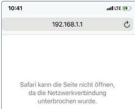
6. Wenn die Änderungen übernommen wurden, wird eine Browser-Fehlerseite angezeigt und Ihr Gerät ist nicht mehr mit dem Router verbunden. Da Änderungen am WLAN-Netzwerk vorgenommen wurden, wird der Router automatisch alle Geräte entfernen, einschließlich des Geräts, das Sie gerade verwenden.
