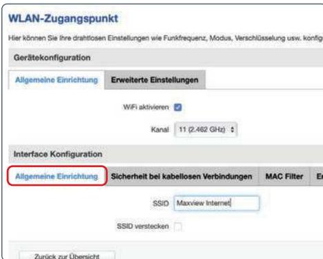
3. Sie werden nun zum Tab „Allgemeine Einrichtung“ weitergeleitet. Tragen Sie im Kästchen „SSID“ den neuen Namen (die SSID) Ihres Routers ein. Wählen Sie den Tab „Sicherheit bei kabellosen Verbindungen“ aus, wenn Sie fertig sind.
