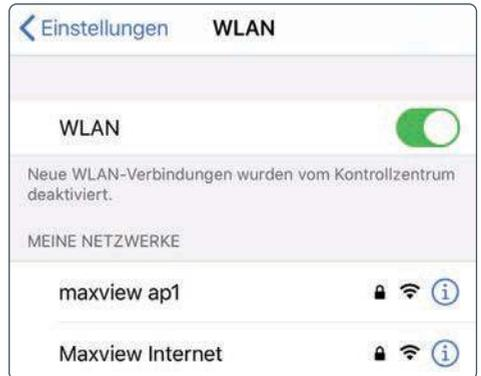
7. Sie können nun die WLAN-Einstellungen Ihres Geräts aufrufen und sich die verfügbaren WLAN-Netzwerke anzeigen lassen. Der Roam-Router wird unter dem Namen angezeigt, den Sie ausgewählt haben. Wählen Sie das Netzwerk aus und geben Sie das neue Passwort ein.
