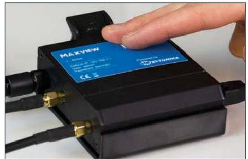
6. Platzieren Sie den Router in der Montagehalterung. Der Router kann jederzeit aus der Halterung genommen werden, wenn Sie die SIM-Karte wechseln müssen.
