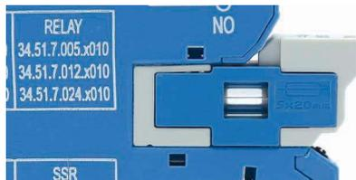
2. Bei gezogenem Sicherungsmodul (z.B. bei ausgelöster Sicherung) bleibt der Ausgang unterbrochen, um die Ursache des Sicherungsausfalls ermitteln zu können (Sicherheitslogik).
