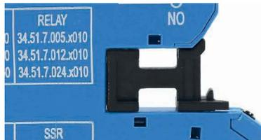
1. Bei Verwendung des Sicherungsmoduls reicht es aus, den Blindstopfen zu entfernen und ihn mit dem Sicherungsmodul zu ersetzen. Die Sicherung befindet sich in Reihe (Serie) zum Wechsler des Ausgangsanschluss (11 bei EMR, 13+ bei SSR, 15 bei EMR Zeitrelais, 15+ bei SSR Zeitrelais).
