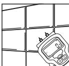
**Έλεγχος του ποσοστού υγρασίας σε δομικά υλικά**
