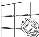
**Kontrola zawartości wilgoci w materiałach budowlanych,** jak np. w betonie, cegłach, jastrychu, kartonach gipsowych, tapetach przed ich dalszą obróbką.
