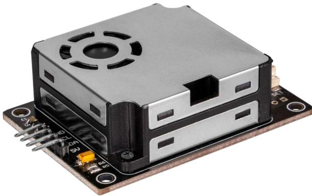
Der HM3301-Sensor ermittelt die Feinstaub-Partikelkonzentration in der Luft mit Hilfe des Streulichtverfahrens ab einer Partikelgröße von 0,3 µm.
