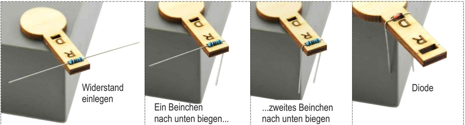
**A Diode auflöten.** Auf Polung (Ausrichtung) achten - Polung wie auf der Platine angezeichnet! Überstehende Drähte kürzen.
