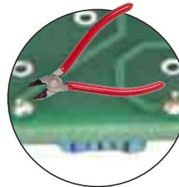
Nach dem Löten die überstehenden Drähte auf der Rückseite mit dem Seitenschneider auf ca. 2 mm kürzen.
