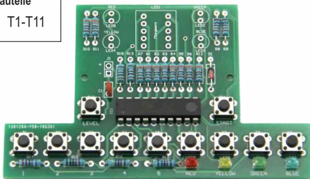
**H 7-Segment Anzeige einlöten.** Hierbei musst du auf die Polung achten. Der „Punkt“ muss zu den Tastern hin nach rechts ausgerichtet sein. Überstehende Dráhte kürzen und die Schutzfolie von Segmentoberfläche abziehen.
