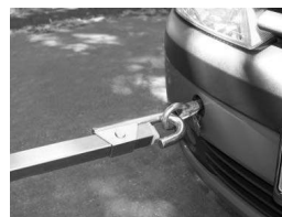
Figuur 1: Aansluiten van de voertuigen
