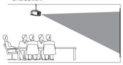
2 Um die Projektion in die richtige Position zu bringen, drücken Sie ♠ und w\u00e4hlen Sie SETUP - Panel Flip Rotate (EINSTELLUNG -Projektionsbild spiegeln/drehen).
