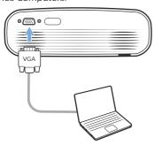
2 Stellen Sie an Ihrem Computer anschließend die korrekte Bildschirmauflösung ein und übertragen Sie das VGA-Signal auf einen externen Monitor oder, wie in diesem Fall, auf die Projektionsfläche des Projektors. Im Folgenden sind die unterstützten Auflösungen aufgelistet:
