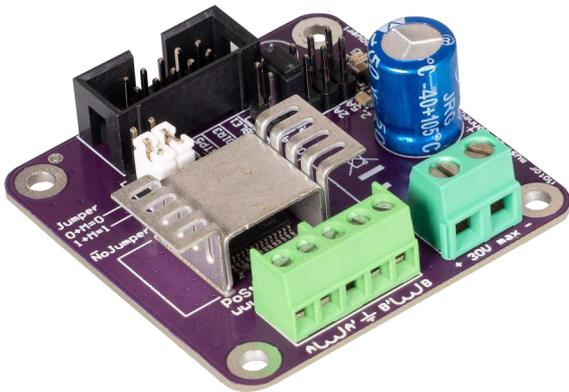
Der PoStep25-256 ist ein hochleistungsfähiger, kostengünstiger Schrittmotortreiber zur Implementierung einer intelligenten Schrittmotorsteuerung - Smooth tune. Der Treiber verfügt über eine fortschrittliche Architektur und Oberflächenmontagetechnologie, um eine außergewöhnliche Leistungsdichte zu erreichen.
