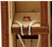
Einzelheit: LDR-Sensor Montage
