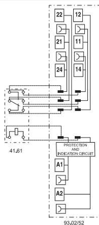
\* Bei einem Dauerstrom > 10 A sind die Anschlüsse 11-21, 14-24, 12-22 zu brücken
