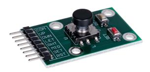
Dieser Navigationsschalter verfügt über 5 Richtungen (Links, Rechts, Oben, Unten, Drücken), sowie über zwei zusätzliche Buttons. Alle Kontakte werden dabei bequem über einen gemeinsamen Masse-Pin geschlossen.
