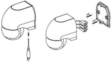
Im Lieferumfang ist Montagematerial für Betonwände / -decken enthalten. Andere Untergründe benötigen u. U. anderes Montagematerial.
