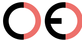
Falsche CE-Kennzeichnung (zu großer Zwischenraum)
