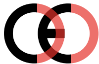
Falsche CE-Kennzeichnung (zu dicht)
