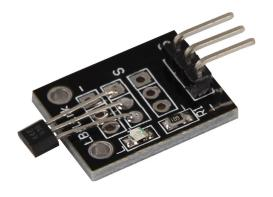
Mit diesem kleinem Hall Magnetfeldsensor, können Sie Magnetfelder mit Hilfe des Digitalen Ausgangs des Sensors und der integrierten Status LED erkennen. Wenn der Sensor in ein Magnetdfeld gehalten wird, leuchtet die LED auf und der Sensorausgang wird Low gesetzt.
