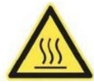
Ne touchez pas les surfaces de l'appareil pendant l'utilisation. La température des surfaces accessibles peut être élevée quand l'appareil est en fonctionnement.
