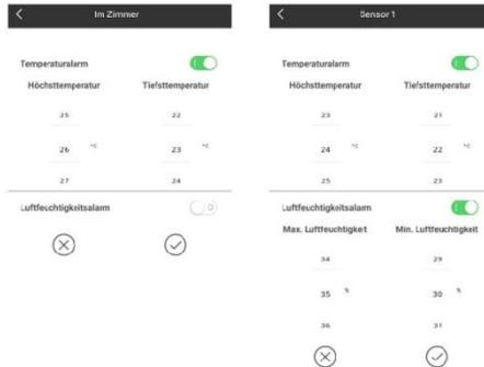
Einstellung des Temperatur- und Luftfeuchtheitsalarms für die Basisstation (links) und den Aussensender (rechts)
