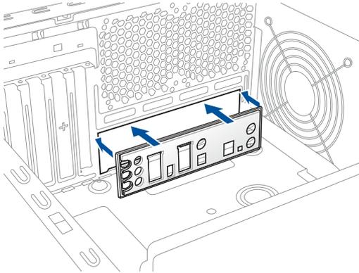
2. Installieren Sie das Motherboard in das Gehäuse. Achten Sie hierbei darauf, dass die hinteren E/A-Anschlüsse genau auf die E/A-Blende in der Gehäuserückwand ausgerichtet sind.
