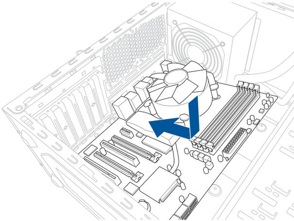
3. Setzen Sie sechs (6) Schrauben in die durch Kreise markierten Bohrlöcher ein, um das Motherboard im Gehäuse zu befestigen.
