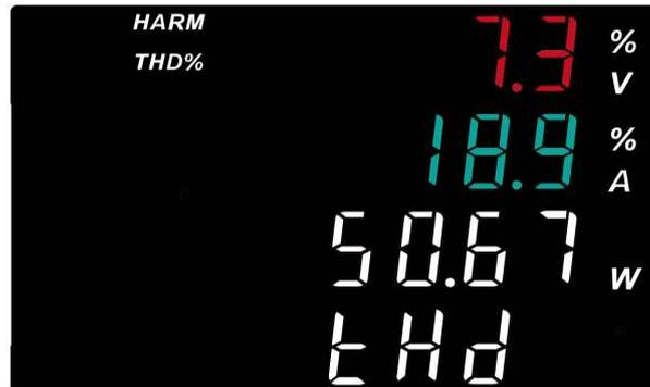
In Fenster 4 wird „tHD “ oder „or01 “~ “or50 “ angezeigt. „tHD “ steht für die gesamte harmonische Verzerrung; „or01 “~ “or50 “ stellt die aktuell ausgewählten harmonischen Zeiten dar. Der Anzeigepunkt von Fenster 4 kann durch [ ▲ ] oder [ ▼ ] umgeschaltet werden. Die Tasten [ ▲ ] oder [ ▼ ] unterstützen die Dauerdruckfunktion. Durch langes Drücken der beiden Tasten können Sie schnell zwischen den Anzeigeelementen wechseln.
