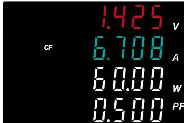
Fenster 1: der gemessene Wert des Spannungsscheitelfaktors, keine Einheit. Der gemessene Wert des Spannungsscheitelfaktors = Spannungsscheitelwert/TRMS-Spannung. Wenn kein Spannungssignal eingegeben wird, wird „-----“ angezeigt.
