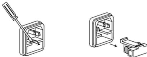
Wenn die Sicherung durchgebrannt ist, ersetzen Sie das Gerät bitte durch eine Sicherung derselben Spezifikation.
