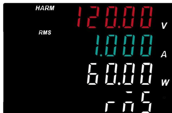
Fenster 1: die gesamte RMS-Spannung (Betriebswert) von 1- bis 50-mal, die Einheit ist V.
