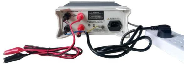
Warnung: Stellen Sie vor dem Anschließen an den Stromkreis sicher, dass die Stromversorgung unterbrochen ist, um einen Stromschlag zu vermeiden.
