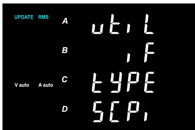
4. Drücken Sie die Taste **【▲】** oder die Taste **【▼】** , um das Typ-Untermenü aufzurufen, und drücken Sie die Taste **【▲】** oder die Taste **【▼】** , um zwischen „SCPI “ und „ **modb**“ zu wechseln .
