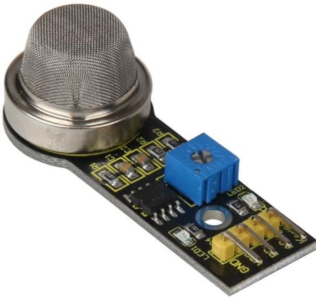
Dieser analoge Gassensor besitzt ein kleines Heizelement mit einem elektronisch-chemischen Sensor. Er ist für die Verwendung in Innenräumen geeignet. Er kann erst nach Beendigung der Aufwärmphase genaue Messwerte ausgeben.
