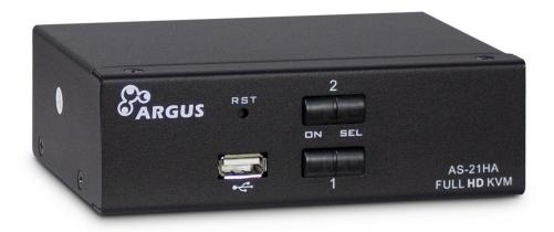
Der **KVM-AS-21HA HDMI** ist ein günstiger 2-Port KVM-Switch mit automatischem Audioumschalter für den Desktopbereich.
