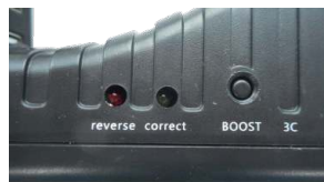
Figura 3: Spie di controllo scatola d'avviamento
