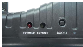
Figure 3 : Lampes de contrôle de la boîte de démarrage
