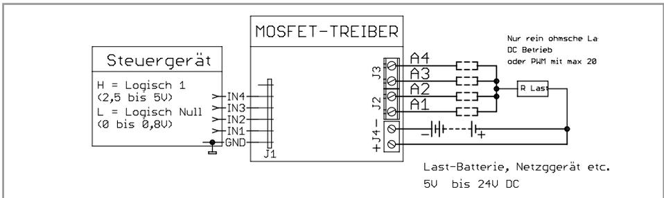
Beim Parallelschalten von Lastausgängen muss die Verteilung am Lastwiderstand erfolgen und alle rückführenden Leitungen müssen sowohl am Lastwiderstand als auch an den Ausgängen des MOSFET-Treibers einwandfrei kontaktieren.
