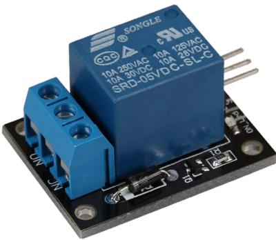
Relais zum Schalten von höherer Spannungen mittels eines 5V Ausgangs. Das Modul kann fest verlötet oder auf einem Breadboard ausgesteckt werden.
