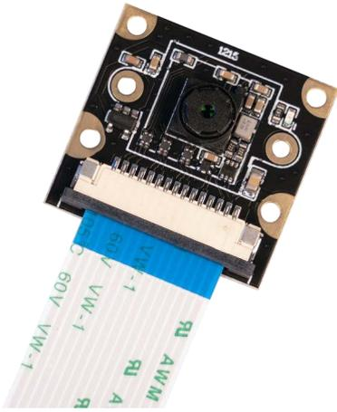
Das Kameramodul für den Raspberry Pi arbeitet mit dem bekannten IMX219 Chip und liefert beste Aufnahmen in 8 MP Qualität bei einem Blickwinkel von 77°.
