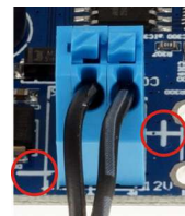
Bild 9: Steckernetzteil an Mainboard anschließen
