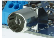
Bild 2: Anlöten Wurfantenne oder IEC Antennenbuchse
