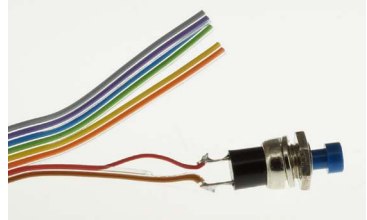
Bild 6: Taster an Flachbandkabel gelötet
