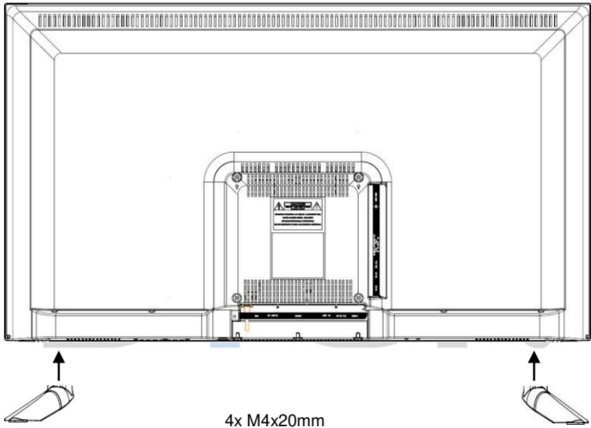
Fixieren Sie die Standfüße in die Vorrichtung, wie auf dem Bild beschrieben und befestigen Sie diese mit den beiliegenden Halterungsschrauben.
