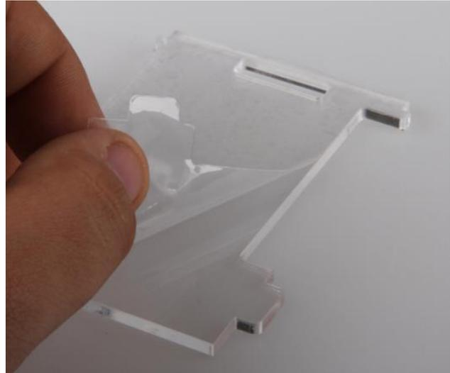
Entfernen Sie die Schutzfolie, bis alle Einzelteile von beiden Seiten von der Schutzfolie befreit sind.
