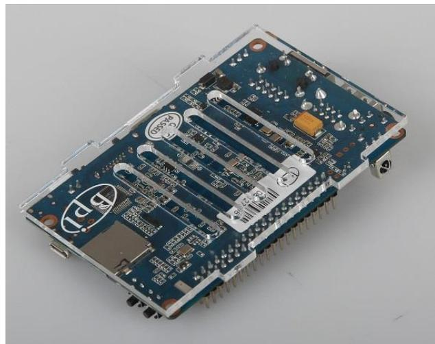
Als nächstes legen Sie die beiden Seitenwände an. Achten Sie hierbei, dass auf der einen Seite die Ausgänge des BananaPi M3 in die Aussparungen eingehängt sind.
