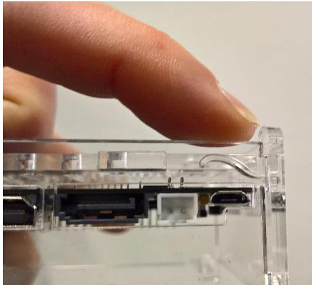
Dies wiederholen Sie auch auf der gegenüberliegenden Seite. Auch hier wird die Seitenwand oben eingehängt und mit leichtem Druck unten fixiert.
