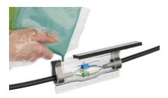
Den Schiebedeckel der Muffe so zurückschieben, dass eine kleine Öffnung vorhanden ist. Durch diese Öffnung das Gießharz in die Muffe gießen.
