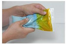
Mischen des Zwei-Komponenten-Gießharz durch gutes Durchkneten (ca. 3 Minuten) des geschlossenen Beutels.
