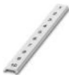
Zackband flach, Streifen, weiß, beschriftet, quer bedruckt: fortlaufende Zahlen 1 ... 10, 11 ... 20 usw. bis 91 ... 100, Montageart: verrasten in flacher Schildchennut, für Klemmenbreite: 6,2 mm, Schriftfeldgröße: 5,15 x 6,15 mm, Anzahl der Einzelschilder: 10
