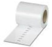
Marker für Klemmen, Rolle, weiß, unbeschriftet, beschriftbar mit: THERMOMARK ROLL 2.0, THERMOMARK ROLL, THERMOMARK ROLL X1, THERMOMARK ROLLMASTER 300/600, THERMOMARK X1.2, THERMOMARK S1.1, perforiert, Montageart: verrasten in Universalschildchennut, verrasten in flacher Schildchennut, für Klemmenbreite: 6,2 mm, Schriftfeldgröße: 6,35 x 6,15 mm, Anzahl der Einzelschilder: 16000
