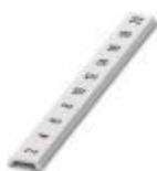
Zackband flach, Streifen, weiß, beschriftet, längs bedruckt: fortlaufende Zahlen 2 ... 20, 22 ... 40, usw. bis 82 ... 100, Montageart: verrasten in flacher Schildchennut, für Klemmenbreite: 6,2 mm, Schriftfeldgröße: 5,15 x 6,15 mm, Anzahl der Einzelschilder: 10
