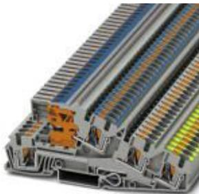
Installationsschutzleiterklemme, Push-in-Anschluss, Querschnitt: 0,2 mm<sup>2</sup> - 6 mm<sup>2</sup>, AWG: 24 - 10, Breite: 6,2 mm, Farbe: grau, Montageart: NS 35/7,5, NS 35/15
