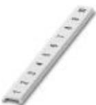
Zackband flach, Streifen, weiß, beschriftet, längs bedruckt: fortlaufende Zahlen 1 ... 10, 11 ... 20 usw. bis 91 ... 100, Montageart: verrasten in flacher Schildchennut, für Klemmenbreite: 6,2 mm, Schriftfeldgröße: 5,15 x 6,15 mm, Anzahl der Einzelschilder: 10
