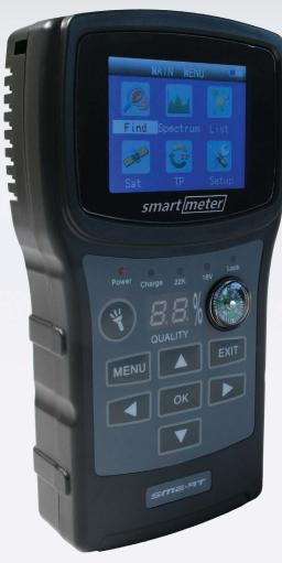
Das **smartmeter ES1** ist ein handliches, digitales Messgerät zur einfachen und schnellen Installation eines DVB-S-Empfangssystems.
