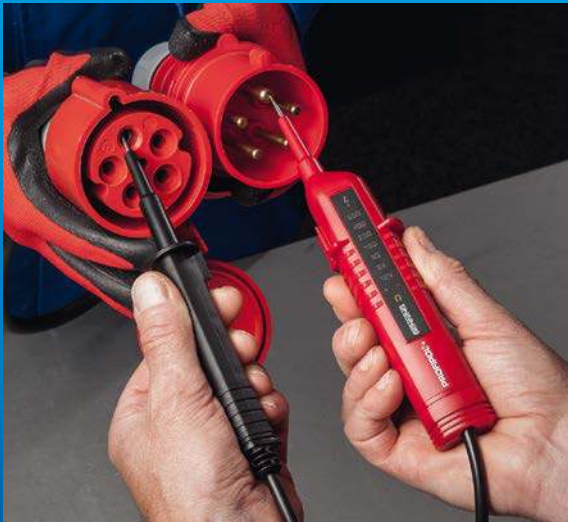
Durchgangsprüfung an Leitungen
