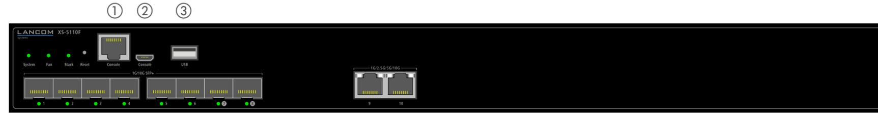
**① Konfigurations-Schnittstellen RJ45 & Micro-USB (Console)**
