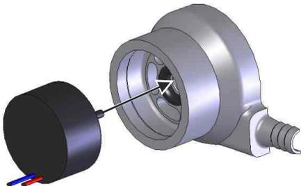
**C** (DT) Dünne Klebewulst rundherum um den Motor aufbringen (dient der Versiegelung). Hierzu einen spaltfüllenden Klebstoff verwenden (z.B. Uhu Max Repair Power).
