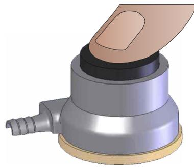
**H** (DT) Gehäuseunterteil aufpressen (kleben nicht erforderlich) und Schlauch montieren.
