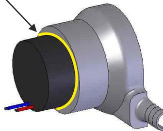
**D** (DT) Nun Motor ganz einschieben und während der Kleber trocknet, den Motor mit einer Klammer fest einpressen. Kleber komplett trocknen lassen.
