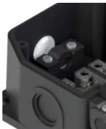
Im Inneren des Gehäuses befindet sich unmittelbar nach der Kabeldurchführung eine Zugentlastung in Richtung der Achse der Bohrung. Diese Lösung ist ideal, um die elektrischen Kabel in Position zu halten und zu verhindern, dass sich eventuelle Zugkräfte oder wiederholte Bewegungen auf die elektrischen Anschlüsse der Kontakteinheit übertragen können. Sie kann umgedreht werden und somit lassen sich sowohl Kabel mit kleinen als auch großen Querschnitten sicher festklemmen.
