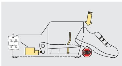
Der Sicherheits-Hebel verhindert das Niederdrücken des Pedals, falls der Fuß nicht komplett eingeführt wird. Auf diese Weise werden Unfälle durch zufälliges Betätigen des Pedals verhindert.
