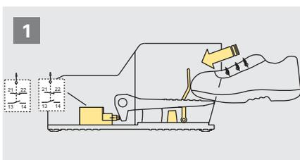
Fußschalter PX mit zwei Kontakteinheiten (2x 1NO+1NC), Sprungkontakt, versetzt, zweistufige Betätigungskraft und Sicherheits-Hebel.
