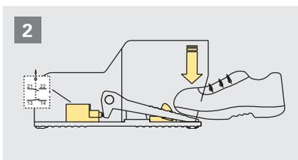
Bei Druck auf das Pedal werden die Kontakte umgeschaltet und die Verriegelungsvorrichtung sperrt Betätiger
