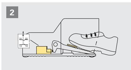
Erst wenn der Fuß komplett in das Pedal eingeführt ist, kann dieses betätigt werden und der Sicherheits-Hebel niedergedrückt werden.
