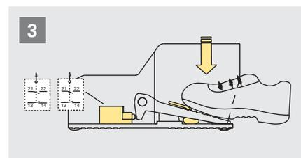
Bei stärkerem Druck (~180 N) auf den Pedalbetätiger schaltet auch die andere Kontakteinheit um. In dieser Position sind beide Kontakteinheiten umgeschaltet.
