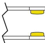
Die Kontakteinheiten dieser Geräte werden auf Anfrage auch mit Goldbeschichtung geliefert. Sie eignen sich für Anwendungen mit Niederspannung oder geringen Strömen und sichern eine hohe Kontaktzuverlässigkeit. Für unterschiedliche Anwendungsgebiete ist die Goldbeschichtung zur Erhöhung der Lebensdauer in zwei Dicken erhältlich: 1 oder 2,5 µm.
