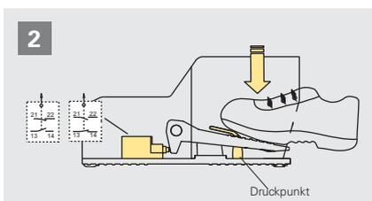
Bei leichtem Druck (~19 N) auf den Pedalbetätiger schaltet eine der beiden Kontakteinheiten um, während die andere ihren Zustand beibehält. Der Pedalbetätiger verbleibt am Drückpunkt.
