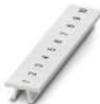
Zackband, Streifen, weiß, beschriftet, längs bedruckt: fortlaufende Zahlen 1 ... 10, 11 ... 20 usw. bis 491 ... 500, Montageart: verrasten in hoher Schildchennut, für Klemmenbreite: 5,2 mm, Schriftfeldgröße: 5,15 x 10,5 mm, Anzahl der Einzelschilder: 10
