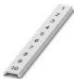
Zackband flach, Streifen, weiß, beschriftet, quer bedruckt: fortlaufende Zahlen 1 ... 10, 11 ... 20 usw. bis 91 ... 100, Montageart: verrasten in flacher Schildchennut, für Klemmenbreite: 5 mm, Schriftfeldgröße: 5,15 x 5,15 mm, Anzahl der Einzelschilder: 10
