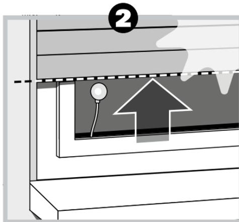
freizugeben. Bei weiterer Sonneneinstrahlung bleibt der Rollladen in dieser Position stehen. Fällt die Helligkeit unter den eingestellten Grenzwert, fährt er bis zum oberen Endpunkt zurück.
