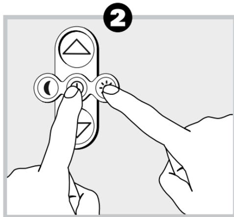
**2 Grenzwert der Sonnenautomatik einstellen:** Betätigen Sie kurz gleichzeitig die [Sonnen]- und [Uhr]-Taste. Die Speicherung des Grenzwertes wird durch kurzes Aufblinker der Sonnen-LED bestätigt.
