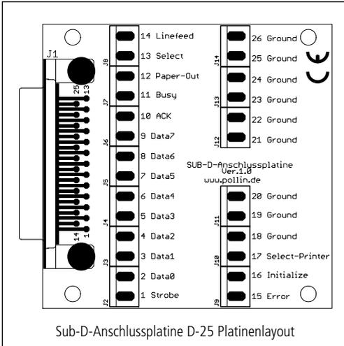
Sub-D-Anschlussplatine D-25 Platinenlayout
