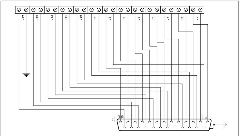
Schaltplan für die Sub-D-Anschlussplatine D-25
