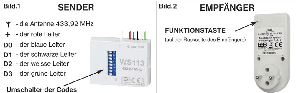
Die Funk-Türglocke BZ8-113 besteht aus dem Empfänger mit einem Codeselbstlernsystem und dem Sender mit Unterputzmontage unter dem Schalter.
