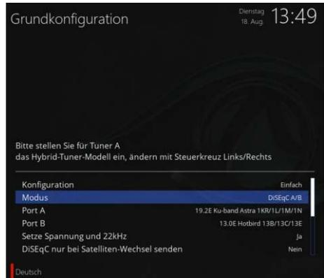
Nun gelangen Sie zur Grundkonfiguration Ihres **Antennentuners B**. Hier programmieren Sie die Einstellung Ihrer Satellitenanlage, ob Sie 1, 2 oder mehrere LNBs verwenden. Diese Programmierung können Sie automatisch oder auch manuell vornehmen.
