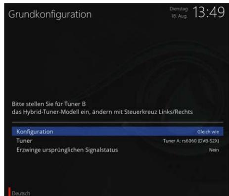
Ist die Konfigurationseinstellung des **Antennentuners B** die selbige wie beim Tuner A, stellen Sie beim Menüpunkt Konfiguration „**Gleich wie**“ und bei der Menüposition Tuner „**Tuner A...**“ ein. Siehe nebenstehende Abbildung.
