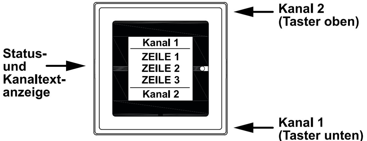
Im oberen und unteren Bereich sind die Bezeichnungen für den oberen und unteren Taster (Kanal 1 und 2) dargestellt.
