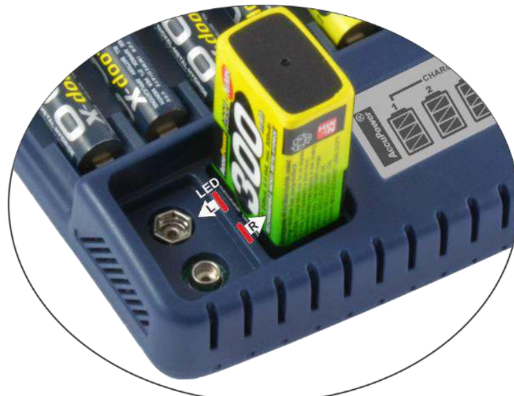
Abbildung 6: Zugehörigkeit der LEDs zum jeweiligen 9V Ladeschacht
