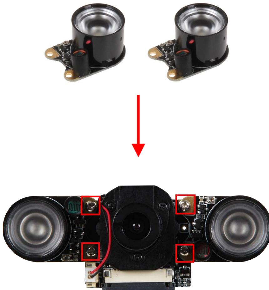
Schließen Sie das Modul nun mit dem beiliegenden Flachbandkabel an die CSI Schnittstelle Ihres Raspberry Pis an.
